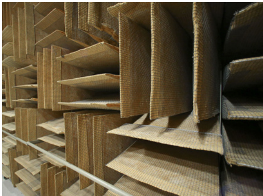
聲學實驗室的無回聲房間內的絕緣擋板以完全吸收聲音反射。
